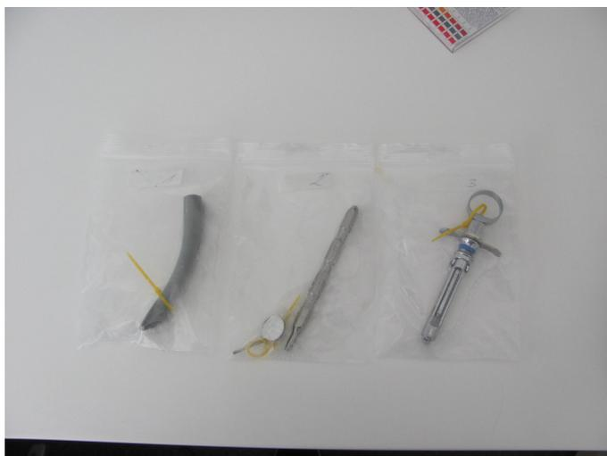
Abb. 11: Prüfkörper Protein-Test
